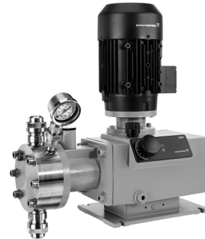
Рис. 16 Насос DMH с контактным манометром для обнаружения утечки из мембраны
