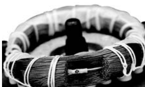
Рис. 21 Датчик РТС, встроенный в обмотку
