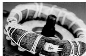
Рис. 23 Термовыключатель, встроенный в обмотку электродвигателя
