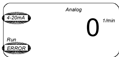
Рис. 25 Дисплей: входной токовый сигнал < 2 мА
