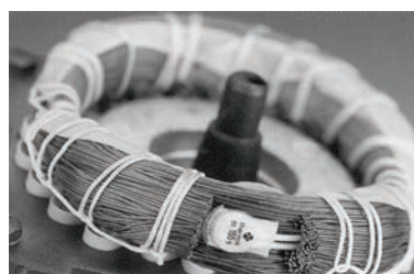
Рис. 28 Термовыключатель, встроенный в обмотку электродвигателя
