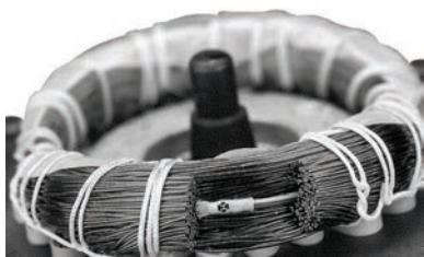
Рис. 26 Датчик РТС, встроенный в обмотку
