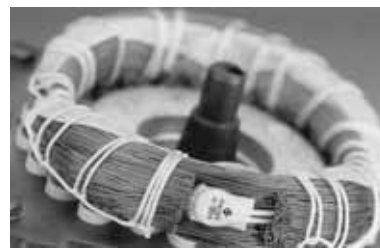
Рис. 28 Термовыключатель, встроенный в обмотку электродвигателя
