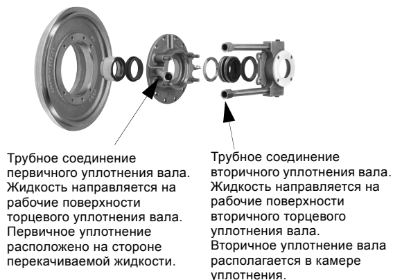
Рис. 1 Подключения промывочной системы для уплотнения типа "tandem" со стандартными уплотнениями
