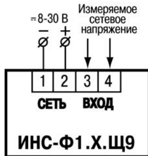
Рисунок Б.2 – Схема подключения прибора ИНС-Ф1.х.Щ9
