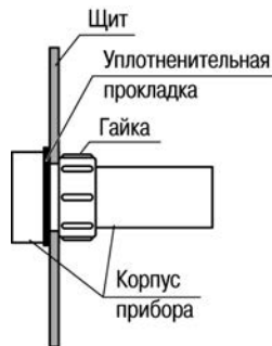
Рисунок 5.2 – Монтаж прибора ИНС-Ф1.Х.Щ9 в щит
