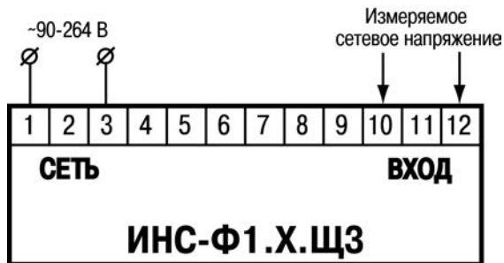
Рисунок Б.1 – Схема подключения прибора ИНС-Ф1.х.ЩЗ
