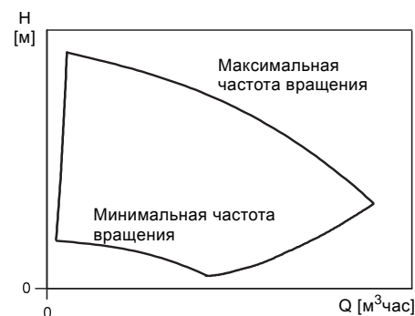
Рис. 29 Рабочий диапазон насосов TPE2
